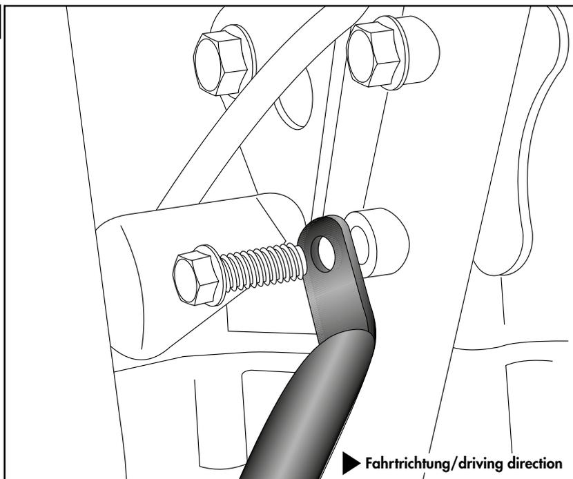
**Montage des Motorschutzbügels vorne:**
