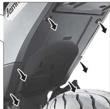
Lösen Sie die markierten Schrauben und Kunststoffdübel der linken und rechten Heckverkleidungen.
