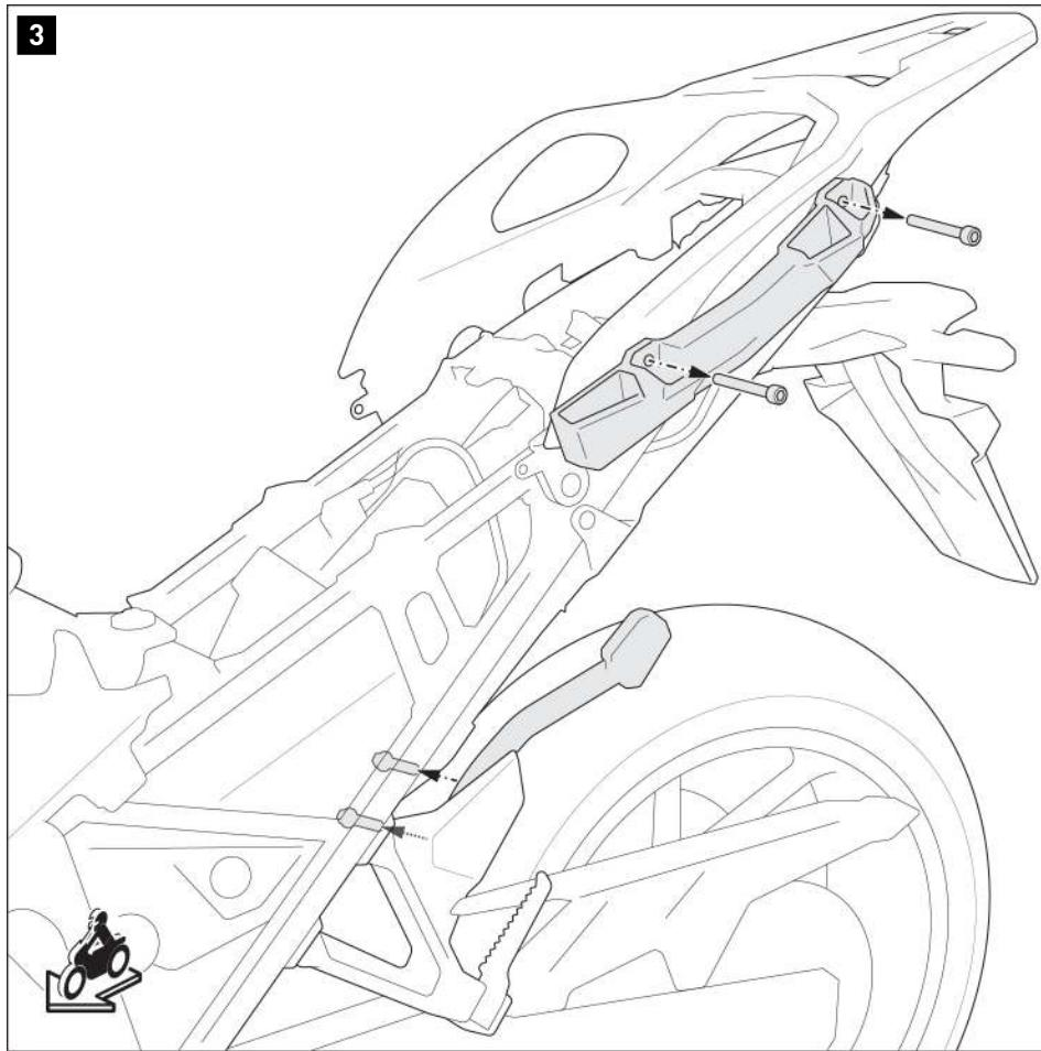
Lösen Sie die markierten Schrauben des original Seitenträgers und entfernen
