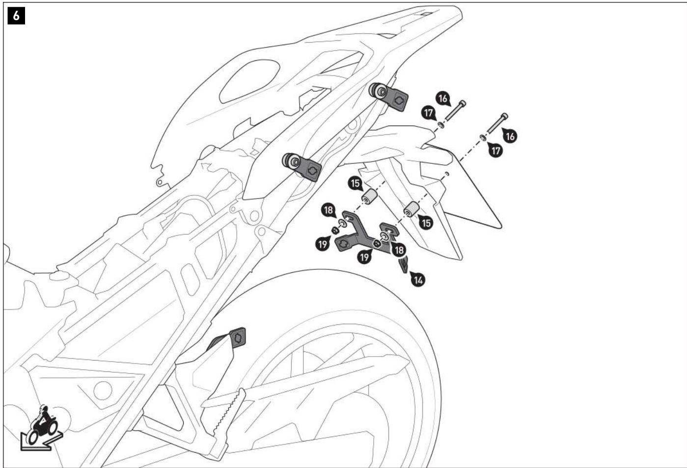
Verschrauben Sie den Querverbinder (14) mit dem Nummernschildhalter am Nummernschildhalter.
