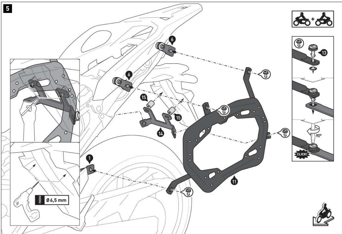
Verbinden Sie die Seitenträger (11) und (12) mit den Schnellverschlüssen (13) an den Befestigungslaschen (1) und (6) sowie dem Querverbinder (14).
