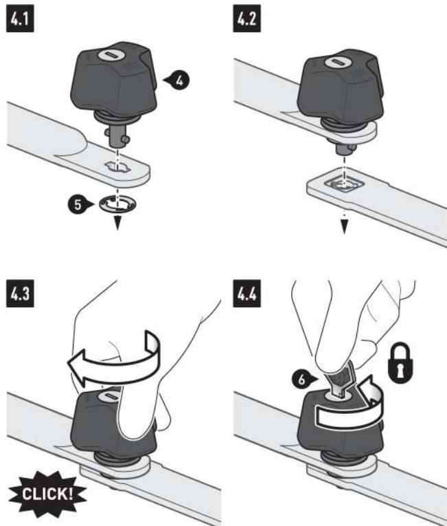
**Diebstahlsicherung für PRO Seitenträger montieren**
