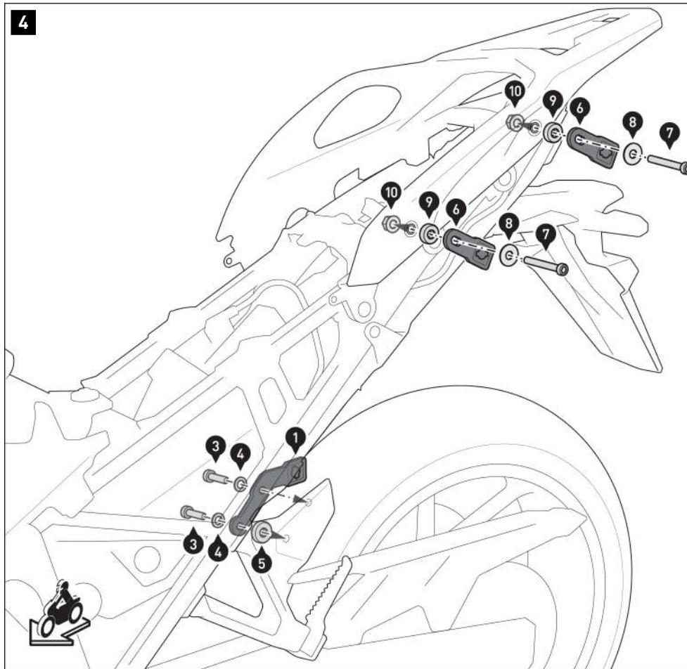
Verschrauben Sie die Befestigungslaschen (1), (2) und (6) beidseitig am Fahrzeug.
