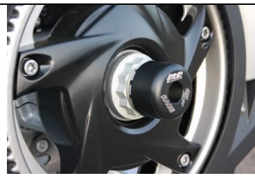
Schutz für Schwinge und Zahnriemenscheibe Art-Nr.50-49
