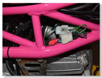
LOCATE THE 4-POLE PLUG OF THE ALTERNATOR. CONNECT THE GIPRO BLACK/GREEN WIRE TO THE BLUE/WHITE BIKE WIRE.
