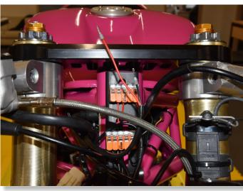
CONNECT THE QSH RED WIRE TO THE BATTERY POSITIVE TERMINAL VIA AN ON/OFF SWITCH.
