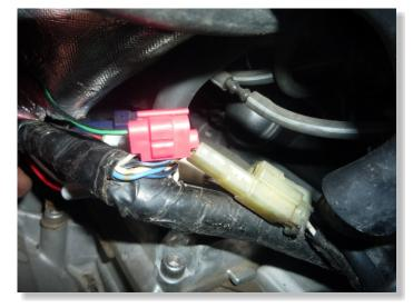
CONNECT THE GPX RED WIRE TO THE BROWN WIRE OF THE REAR BRAKELIGHT SWITCH CONNECTOR.
