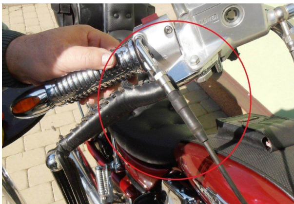
Namontovaná opravná spojka
