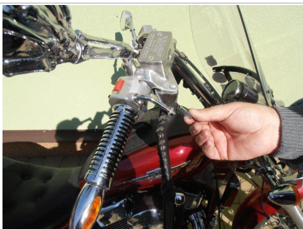
Vyšroubujeme seřizovací nástavec, kontramatku ponecháme a našroubujeme nadoraz
