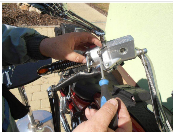
Rozebereme domeček plynové přípusti
