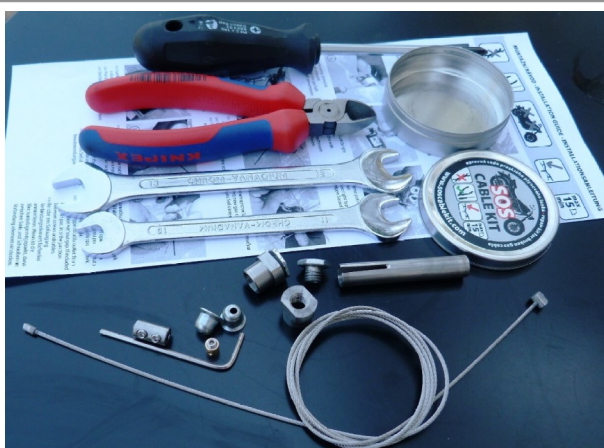
Rozložená opravná sada a potřebné nářadí
