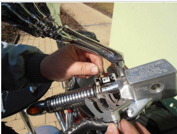
Vyndáme váleček (nip) s utrženým lankem
