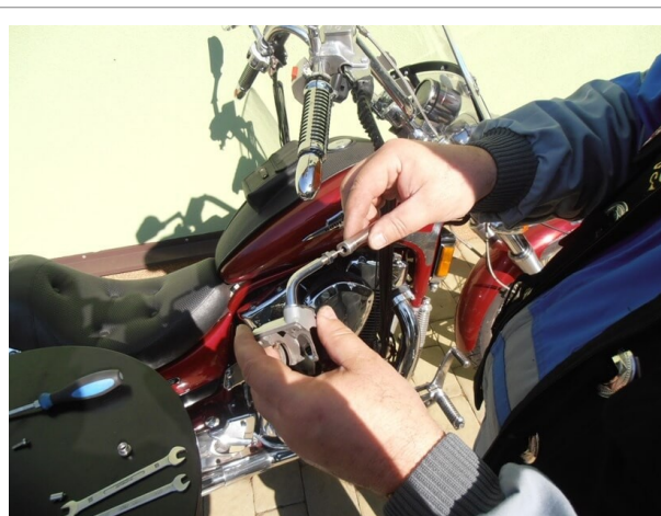
Těleso našroubujeme na konec závitu
