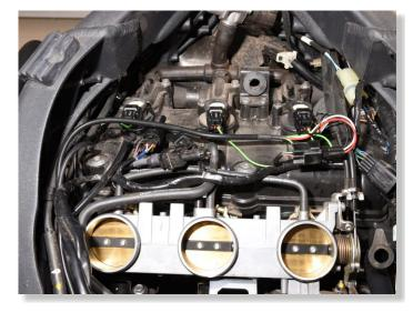
CONNECT THE QSH BLACK WIRE TERMINAL TO THE MAIN CHASSIS GROUND.
