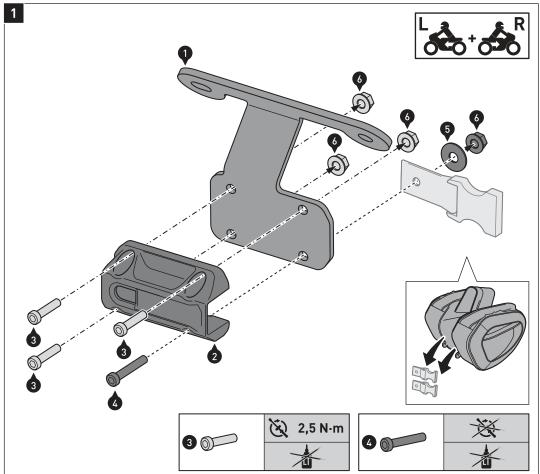
Montieren Sie die gezeigten Teile an den Anbaublechen (1) (linkes Anbaublech gezeigt).
