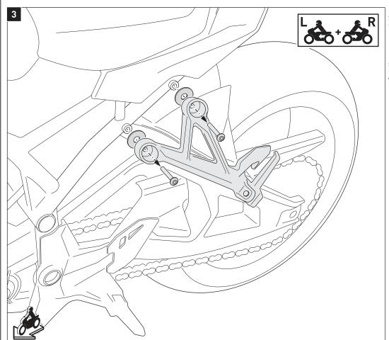
Lösen Sie beidseitig die original Schrauben der Soziusfußrastenhalter und entfernen Sie diese vom Fahrzeug.
