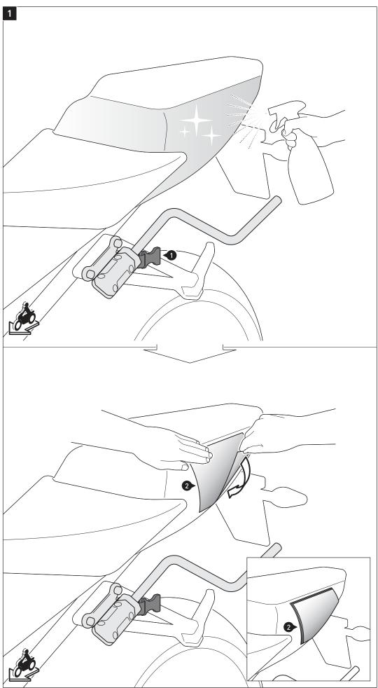
**DE -** Nachdem Sie die Abstandsbügel an Ihrem Fahrzeug montiert haben, müssen Sie die Auflageflächen der Satteltaschen mit der beigepackten Lackschutzfolie (2) bekleben, um Beschädigungen zu vermeiden. Reinigen Sie die zu beklebende Fläche vor dem Aufbringen der Lackschutzfolie gründlich von Fett- und Schmutzrückständen. **ACHTUNG: Scharfkantige Ecken**
