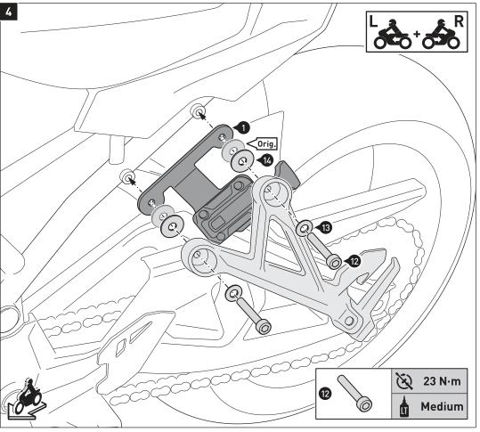
Verschrauben Sie die Anbaubleche (1) mit den Soziusfußrastenhaltern und den original Unterlegscheiben (Orig.) beidseitig am Fahrzeug, wie in der Zeichnung gezeint
