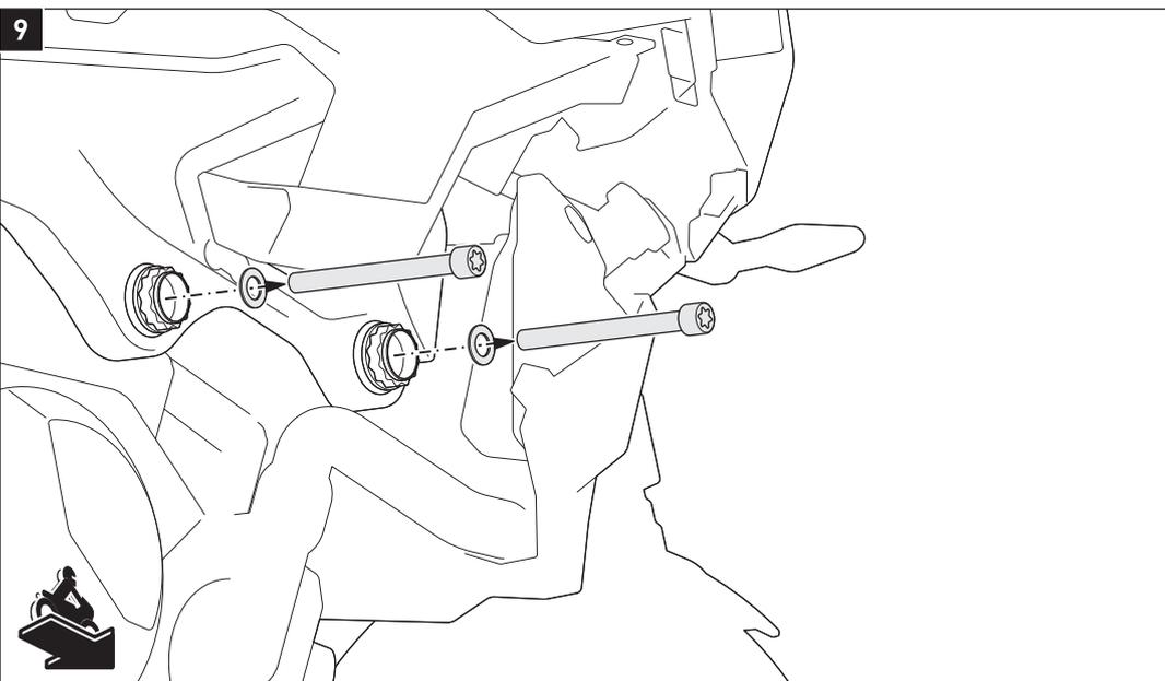
Entfernen Sie die beiden **rechten** Motorhalteschrauben und Unterlegscheiben vom Fahrzeug.
