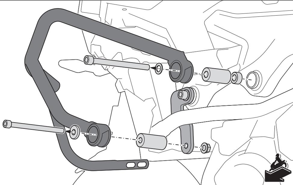
Entfernen Sie den **linken** Sturzbügel nun wieder vom Fahrzeug.
