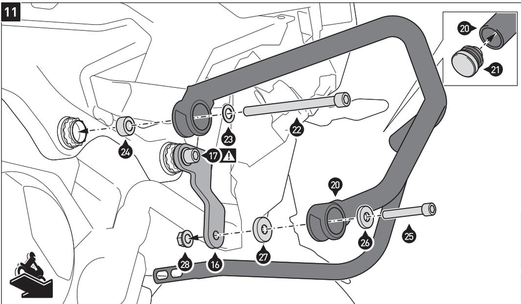
Verschrauben Sie den **rechten** Sturzbügel (20) am Anbaublech (16) und Fahrzeugrahmen.
