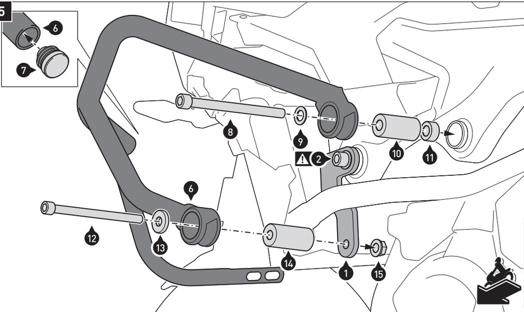
Verschrauben Sie den **linken** Sturzbügel (6) am Anbaublech (1) und Fahrzeugrahmen. Ziehen Sie die Schrauben (8) und (12) noch nicht an. **Ziehen Sie die Schraube (2) nach Herstellerangaben an.**
