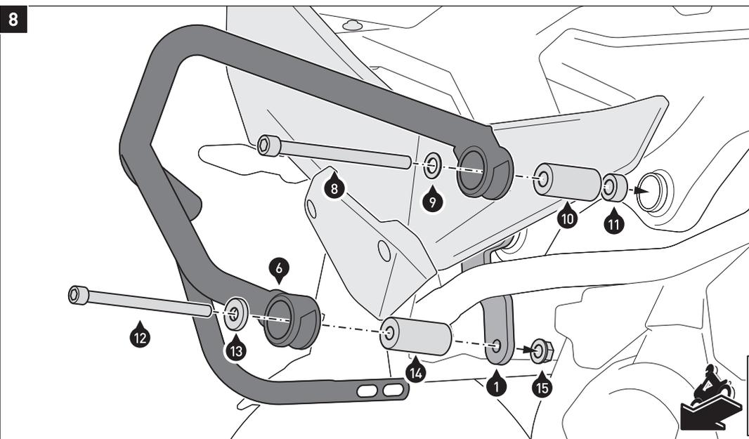
Verschrauben Sie den **linken** Sturzbügel (6) am Anbaublech (1) und Fahrzeugrahmen. Ziehen Sie die Schrauben noch nicht an.
