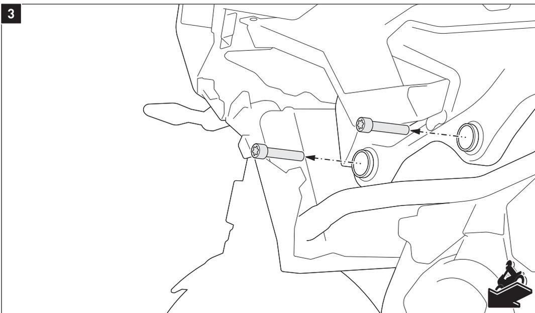
Entfernen Sie die beiden **linken** Motorhalteschrauben vom Fahrzeug.
