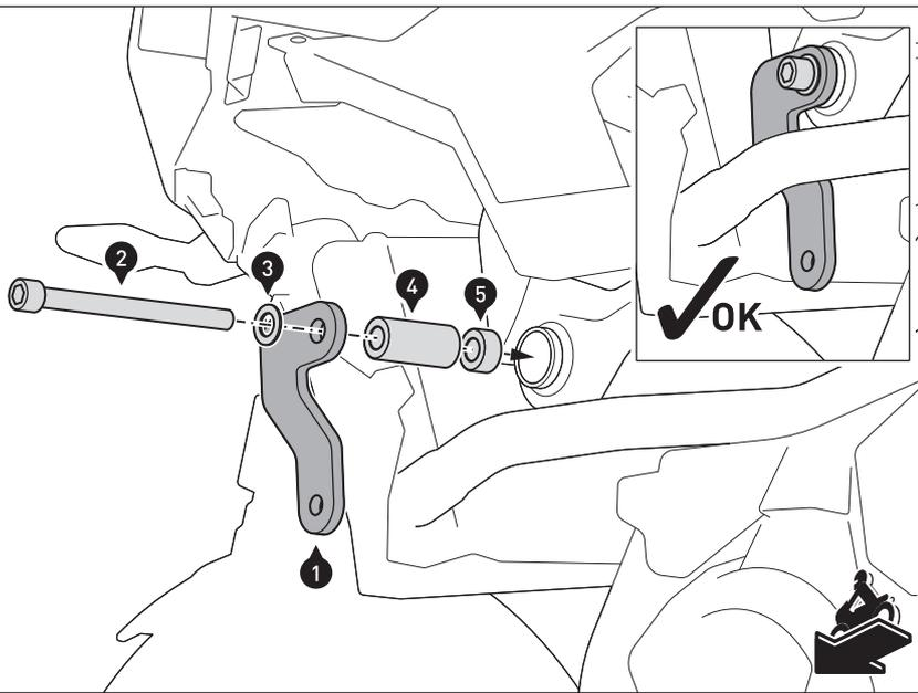
Verschrauben Sie das Anbaublech (1) hinter dem Kühlerschlauch am Fahrzeugrahmen.
