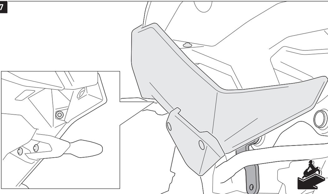
Verschrauben Sie die **linken** Verkleidungsteile wieder mit äußerster Vorsicht am Fahrzeug. Ziehen Sie die original Schrauben (Orig.) nach Herstellerangaben an.
