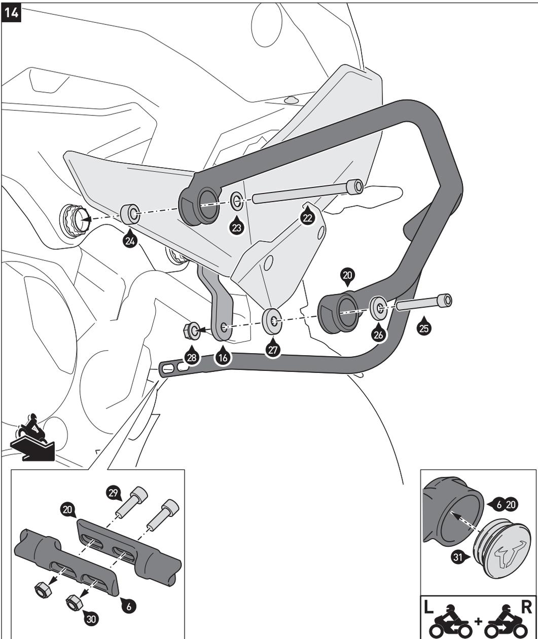
Verschrauben Sie den **rechten** Sturzbügel (20) am Anbaublech (16) und Fahrzeugrahmen.
