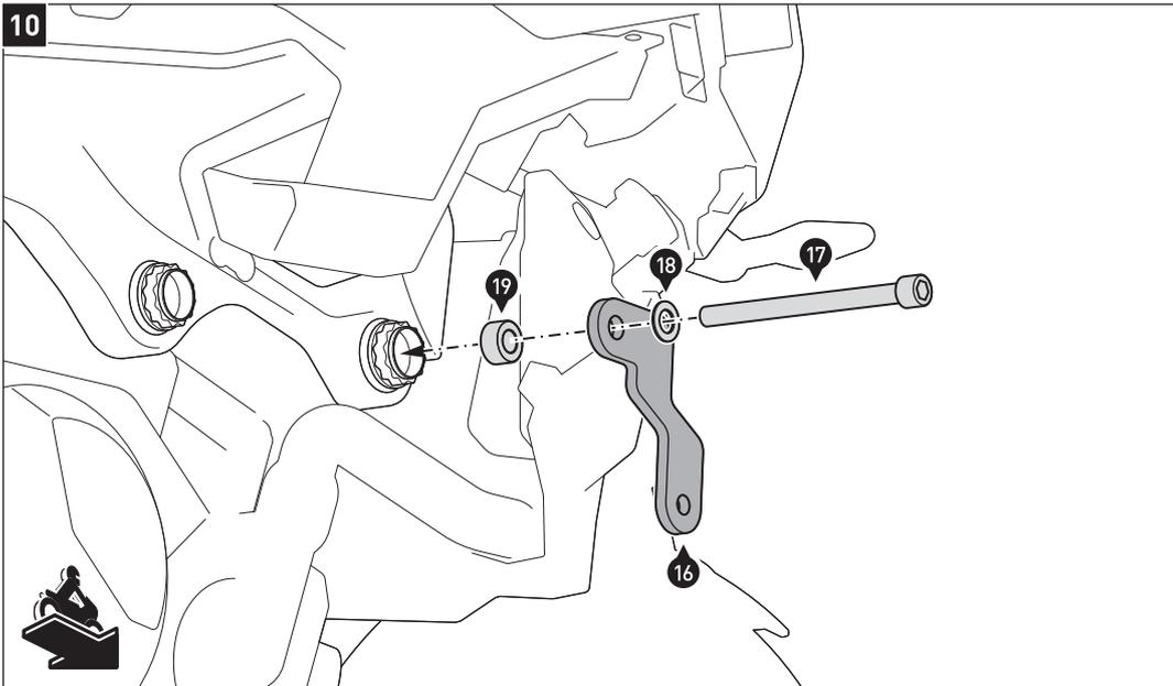
Verschrauben Sie das Anbaublech (16) am Fahrzeugrahmen.
