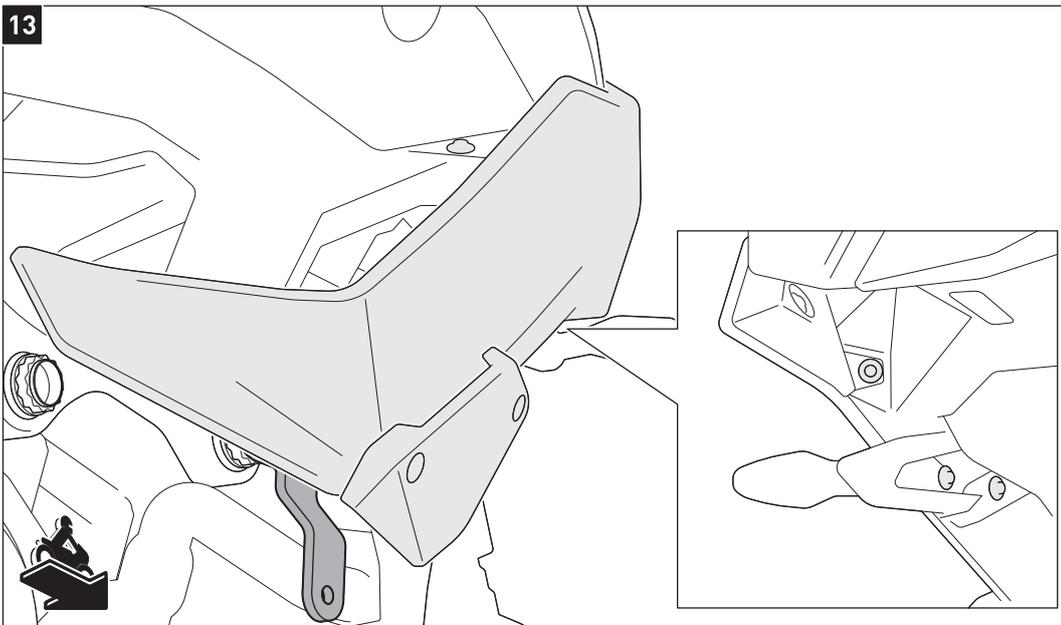
Verschrauben Sie die **rechten** Verkleidungsteile wieder mit äußerster Vorsicht am Fahrzeug. Ziehen Sie die original Schrauben (Orig.) nach Herstellerangaben an.
